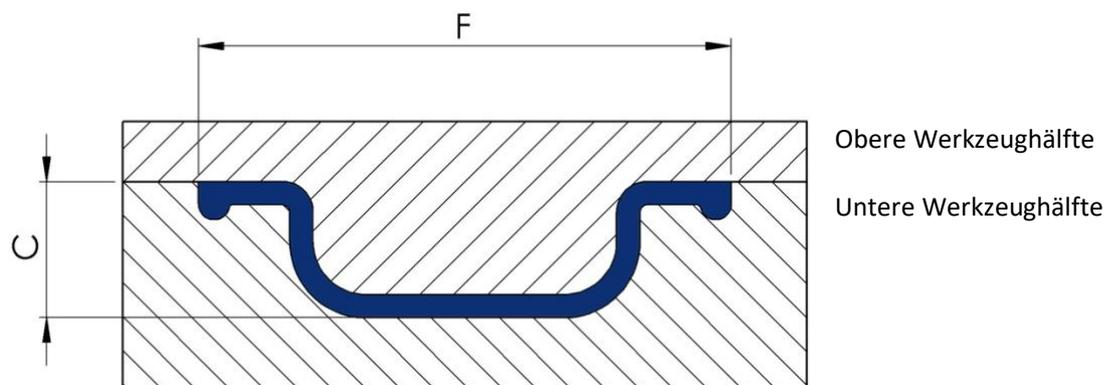
Abbildung Werkzeug: Formschlussmaße C sind abhängig von der Dicke des Austriebs in der Formtrennung und eines möglichen seitlichen Versatzes der Werkzeughälften
